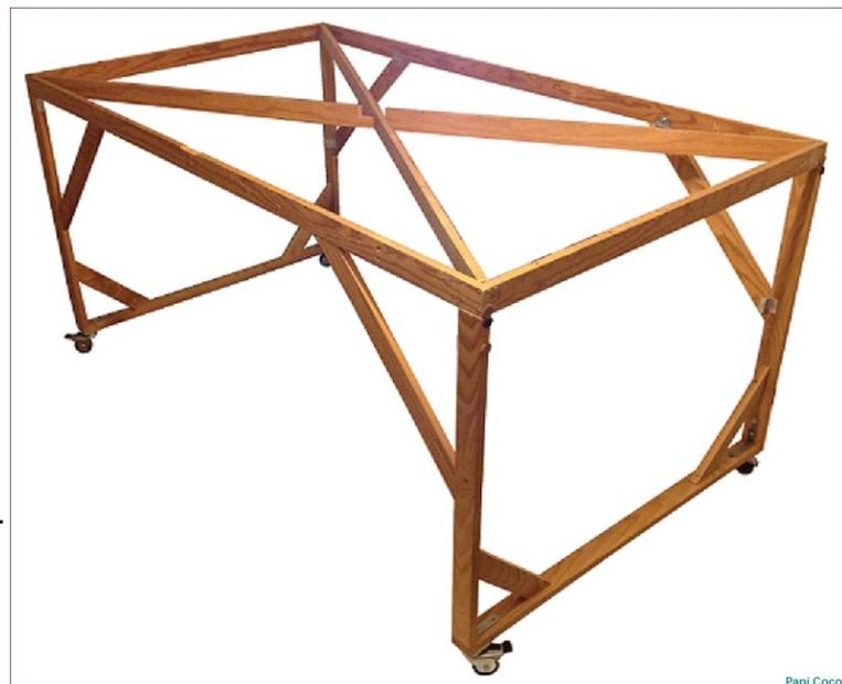
Avec la disparition du réseau **PRCI MAXI** et la création du réseau **PR**, la longueur du châssis devenait trop importante. Je l'avais donc complètement démonté pour le raccourcir en recoupant les longueurs et les diagonales. Je n'avais pas touché à la largeur qui restait inférieure à celle du réseau (dépassement de 12cm non gênant).
